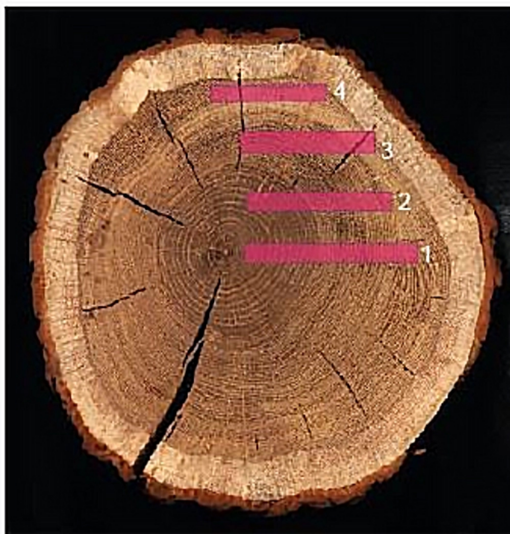
Fig. 8. Schéma de la section transversale d'un tronc de chêne montrant les différentes orientations de débitage des planches :
