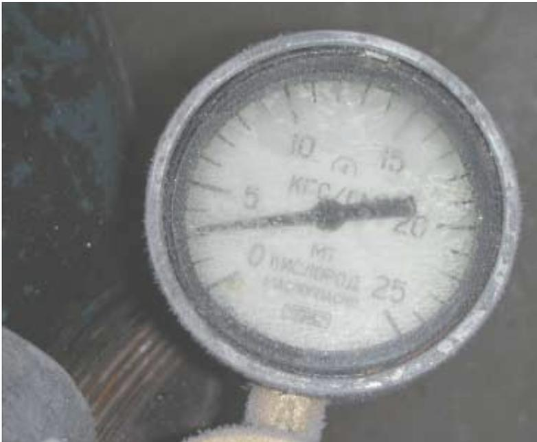
Manomètre de pression de sortie de l'azote dans la bulle
